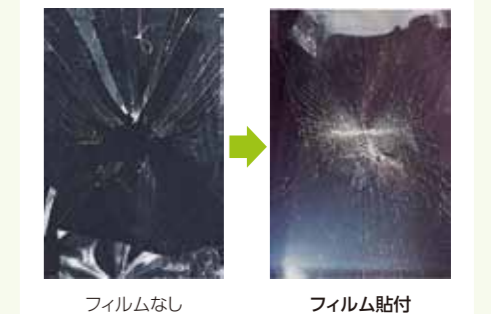
■ 衝撃による飛散防止の実験 JIS A 5759に準拠
